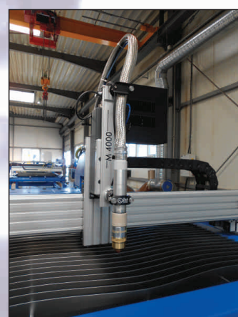
Zdvih hořáku s automatickým hlídáním výšky, dotykovým čidlem a 3D kolizním snímačem
