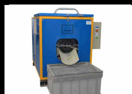
Vibrační omílačka Omílbrus OVV 200, r. v. 2008
