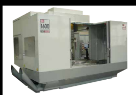
Čtyřosé horizontální CNC centrum Haas EC-1600HE, r. v. 2008
