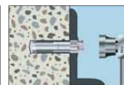
5. Upevnit díl, aplikovat upevňovací moment.
