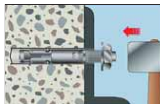
3. Prostrčte hmoždinku upevňovacím dílem a zatlačte ji.
