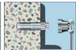
5. Upevnit díl, aplikovat utahovací moment.
