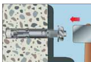
3. Prostrčte hmoždinku upevňovaným dílem a zatlučte ji.
