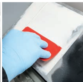
Nanesení jemného plniva TEROSON UP 335 FF
