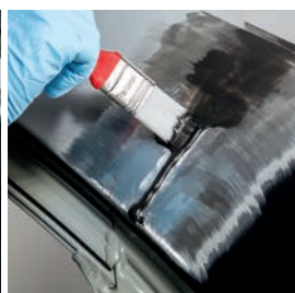
Nanesení ochranné vrstvy proti rozpojování pomocí přípravku TEROSON EP 5055
