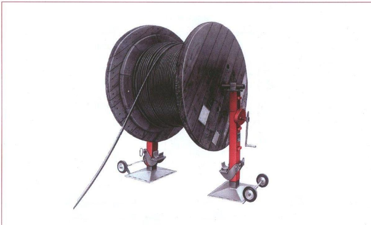
**Tato ručně ovládaná zařízení zvedají těžké lanové bubny do hmotnosti 16 t a průměru 3400 mm a dovolí bezpečně a efektivně odvíjet lano. Tyto robustní vřetenové zvedáky odpovídají bezpečnostním předpisům podle BGV D8 a udrží břemeno v kterékoli poloze. Široké podstavce jsou zárukou vysoké stability. Údržba těchto zvedáků je velmi snadná. Dají se snadno přesouvat z místa na místo na celopřevýžových kolečkách.**
